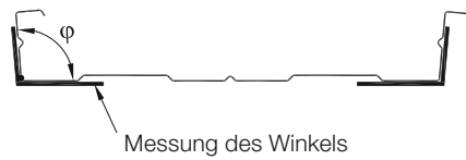
Abbildung 3.26: Messung des Eckwinkels Gurt/Steg
